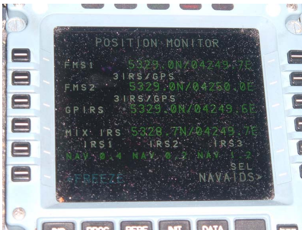
Obr. 11 Kontrola presnosti navigačného systému na lietadle OK-NEO dňa 12.05.2009 na lete ALA – PRG, OK-181, nad územím Kazachstánu Foto autor
