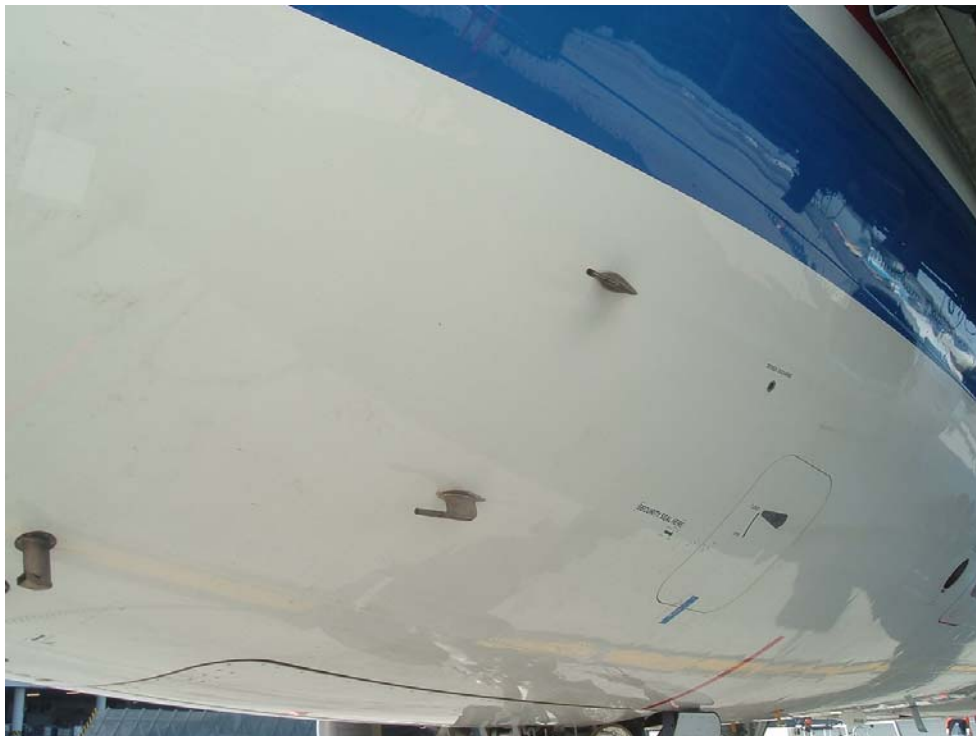
Obr. 17 Detail na pitotove trubice a snímač celkovej teploty Foto autor
