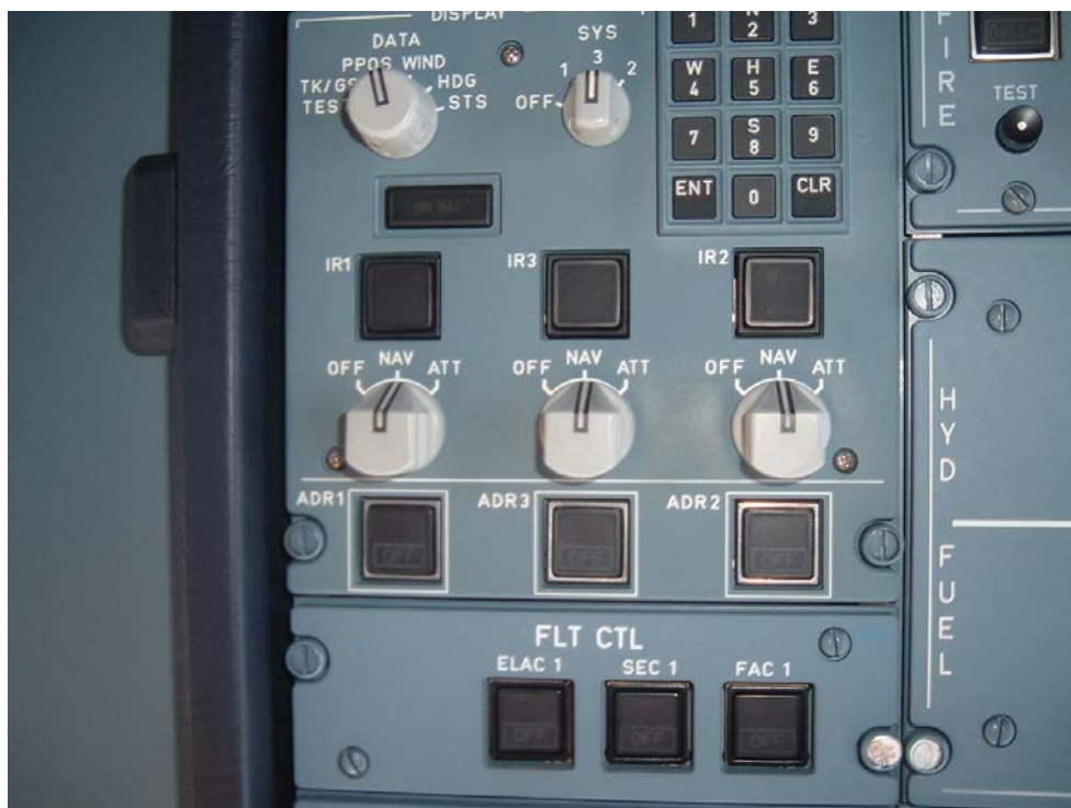
Obr. 10 Ovládací panel ADIRU ktorý sa nachádza nad hlavou kapitána Foto autor
